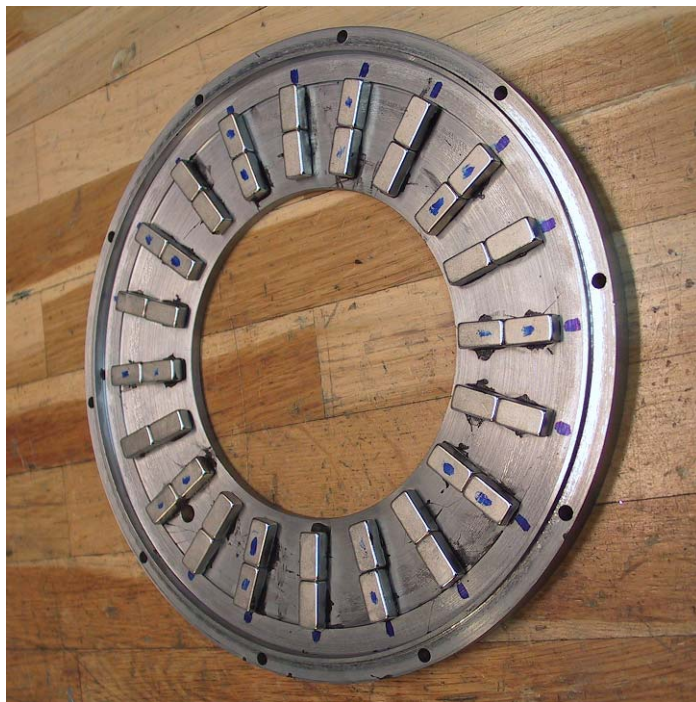
Bild 19. Bakstycke med pålimmade NdFeB magneter
